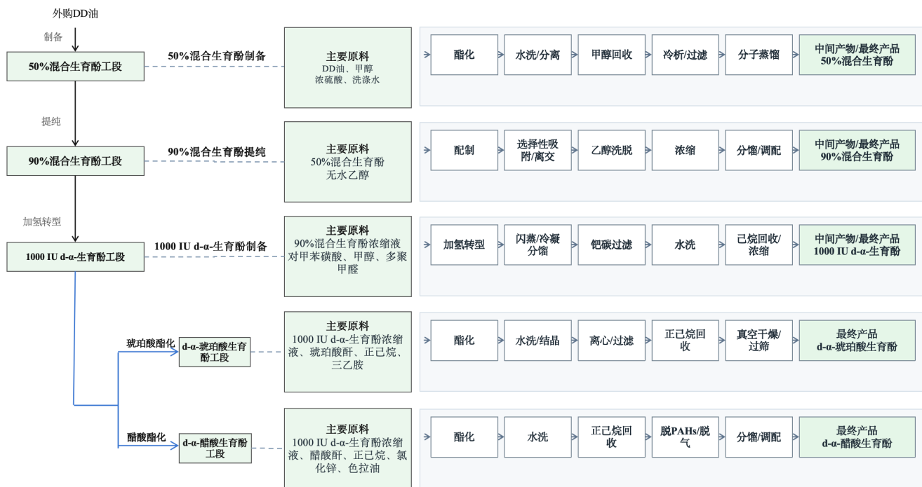
图3.3-1 企业现状在产产品整体生产工艺流程简图
